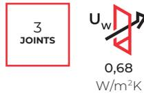
\* -  $U_w$  pour la fenêtre avec ouverture MB-86N SI avec les dimensions d'ouvrant de 1700x2150 mm, avec verre  $U_g=0,5$  W/(m<sup>2</sup>K), avec intercalaire chaud
