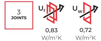
\* -  $U_w$  pour la fenêtre avec ouverture MB-79N SI avec les dimensions d'ouvrant de 1700x2150 mm, avec verre  $U_g=0,5$  W/(m<sup>2</sup>K), avec intercalaire d'espacement
